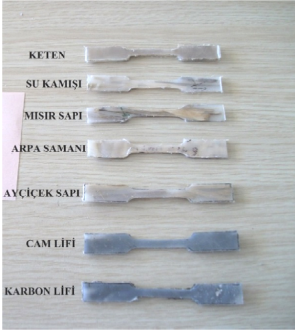
Şekil 5. Çekme testi için hazırlanan örnekler
