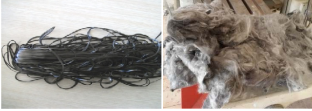
Şekil 3. Çalışmada kullanılan sentetik lifler (a) Karbon lifi, (b) Cam yünü (Kolektör şiltesi)
