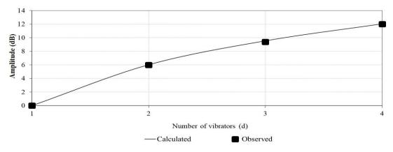
Figure 6b. Variation of peak amplitudes with number of vibrator. Şekil 6b. Pik genliğin vibratör sayısı ile değişimi.
