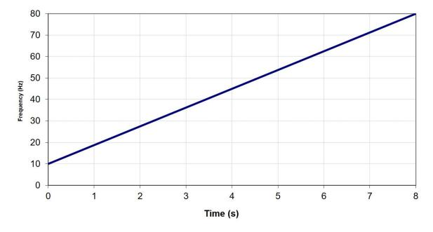
Figure 2a. Frequency-time relation of a linear sweep. Şekil 2a. Bir lineer sweep'in frekans-zaman ilişkisi.
