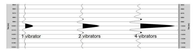
Figure 6a. Autocorrelation wavelets for different number of vibrator. Şekil 6a. Farklı vibratör sayıları ile elde edilmiş sweep'lerin otokorelasyon dalgacığı.
