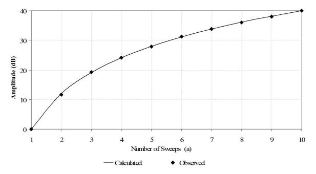
Figure 3b. Variation of peak amplitudes with number of sweep. Şekil 3b. Pik genliğin sweep sayısı ile değişimi.
