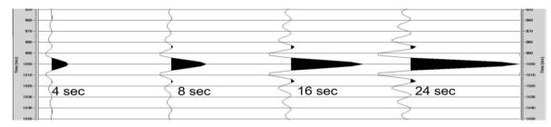
Figure 4a. Autocorrelation wavelets for different sweep length. Şekil 4a. Farklı uzunluktaki sweep'lerin otokorelasyon dalgacığı.
