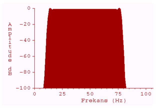
Figure 2c. Linear sweep in the frequency domain. Şekil 2c. Lineer sweep'in frekans ortamında görünüşü
