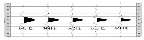
Figure 7a. Autocorrelation wavelets for different sweep bandwidth. Şekil 7a. Farklı sweep band genişliği ile elde edilmiş sweep'lerin otokorelasyon dalgacığı.
