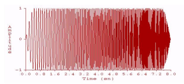
Figure 2b. Linear sweep in the time domain. Şekil 2b. Lineer sweep'in zaman ortamında görünüşü.
