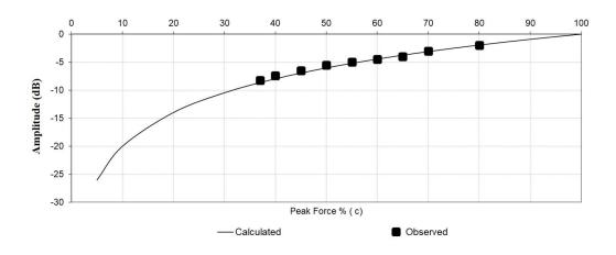
Figure 5b. Variation of peak amplitudes with peak-force. Şekil 5b. Pik genliğin sürüş seviyesi ile değişimi.
