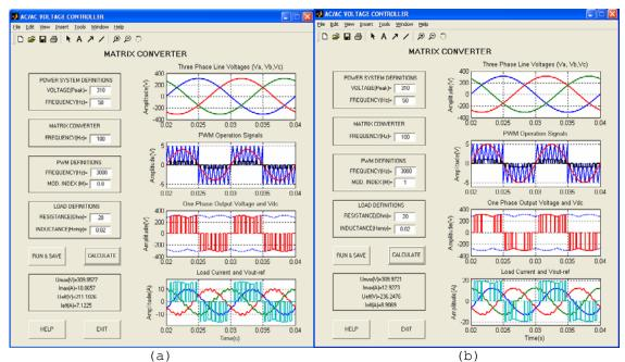
Figure 4. The individual window of matrix converter for different modulation indexes, a) M=0.8, b) M=1 (Şekil 4. Farklı modülasyon indeksleri için matrix konverter özel penceresi, a) M=0.8, b) M=1)
