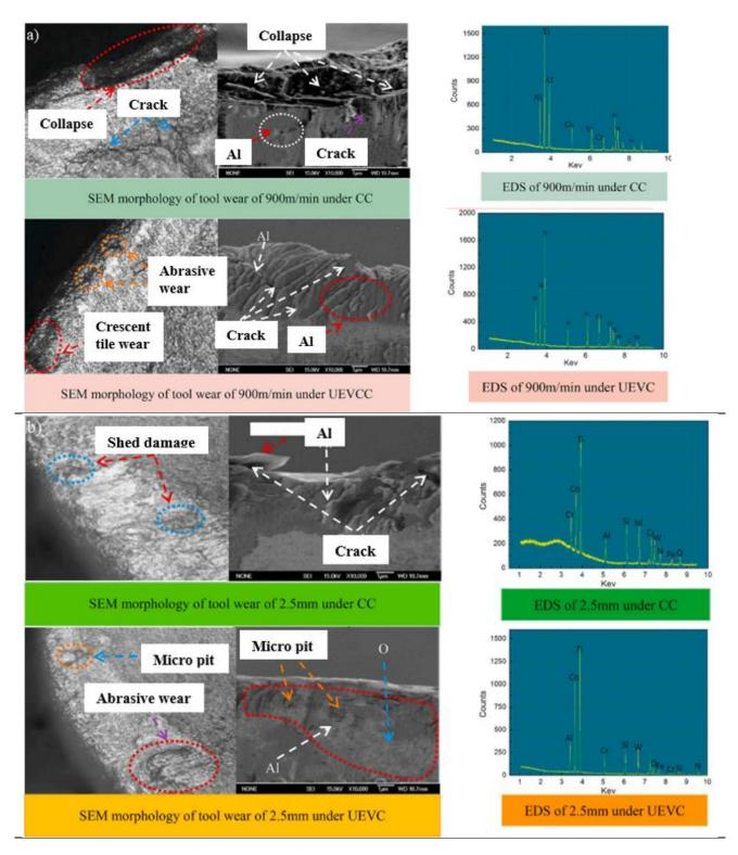
Figure 4. Tool wear in CC and UEVC, a) SEM and EDS tool wear images for 900 m/min and b) SEM and EDS tool wear images for *a*<sub>p</sub> of 2.5 mm [23] (CC ve UEVC'de takım aşınması, a) 900 m/dak için SEM ve EDS takım aşınma görüntüleri ve b) 2,5 mm kesme derinliği için SEM ve EDS takım aşınma görüntüleri)
