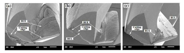
Figure 5. BUE ve BUL formation on the drills, a) Al-7Si, b) Al-7Si-4Zn and c) Al-7Si-4Zn-3Cu [24] (Matkaplarda yığıntı talaş ve yığıntı katman oluşumu)
