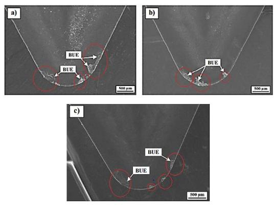
Figure 7. BUE formations at the different V<sub>c</sub> values for Al-25Zn-3Cu alloy, a) 250 m/min, b) 350 m/min and c) 450 m/min [26] (Al-25Zn-3Cu alaşımı için farklı kesme hızı değerlerinde yığıntı talaş oluşumları)
