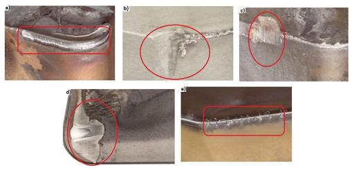
Figure 1. Wear mechanisms on the CT, a) Flank wear, b) Notch wear, c) BUE, d) Crater wear and e) Thermal crack [18] (Kesici takımdaki aşınma mekanizmaları, a) Serbest yüzey aşınması, b) Çentik aşınması, c) Yığıntı talaş, d) Krater aşınması ve e) Termal çatlak)
