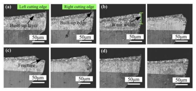
Figure 2. Wear morphologies on micro end mills for machining length of 480 mm, a) K55SF, b) DK500UF, c) DK450UF and d) DK120UF [21] (480 mm işleme uzunluğu için mikro parmak frezelerde aşınma morfolojileri)
