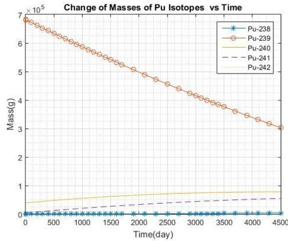
**Fig. 11.** Temporal variation of density (Pu isotopes) in the HTGR full core with SiC fuel pellet clad (SiC yakıt peleti kaplı HTGR tam çekirdeğindeki yoğunluğun (Pu izotopları) geçici değişimi)
