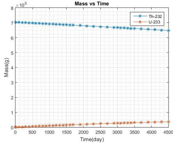
**Fig. 10.** Temporal variation of density ( $^{232}\text{Th}$  and  $^{233}\text{U}$ ) in the HTGR full core with SiC fuel pellet clad (SiC yakıt peleti kaplı HTGR tam çekirdeğinde geçici yoğunluk değişimi ( $^{232}\text{Th}$  ve  $^{233}\text{U}$ ))
