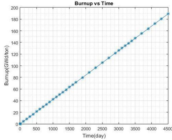
**Fig. 8.** Changes of the burnup values for 2.16 g/cm<sup>3</sup> graphite density of HTGR full core (HTGR tam çekirdeğin 2,16 g/cm<sup>3</sup> grafit yoğunluğu için yanma değerlerinin değişimi)
