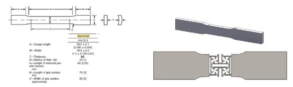
Figure 2. Analyzed specimen dimensions, template, and sample (Analiz edilen numune boyutları, şablon ve örnek)
