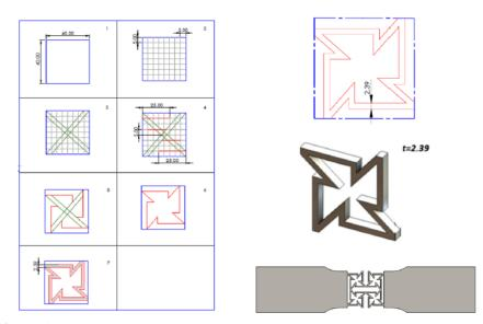
Figure 1. Design stages of the unit geometry (Birim geometrisinin tasarım aşamaları)
