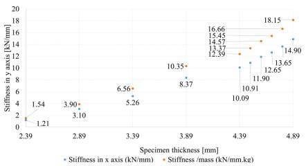
Figure 6. Results of stiffness and stiffness/mass ratio values of examined specimens with respect to inner geometry thickness (İncelenen numunelerin iç geometri kalınlığına göre sertlik ve sertlik/kütle oranı değerlerinin sonuçları)
