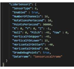
FIGURE 2. Drone LIDAR parameters in AirSim.
