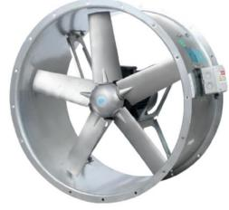
Fig. 4. The axial fan used for test
