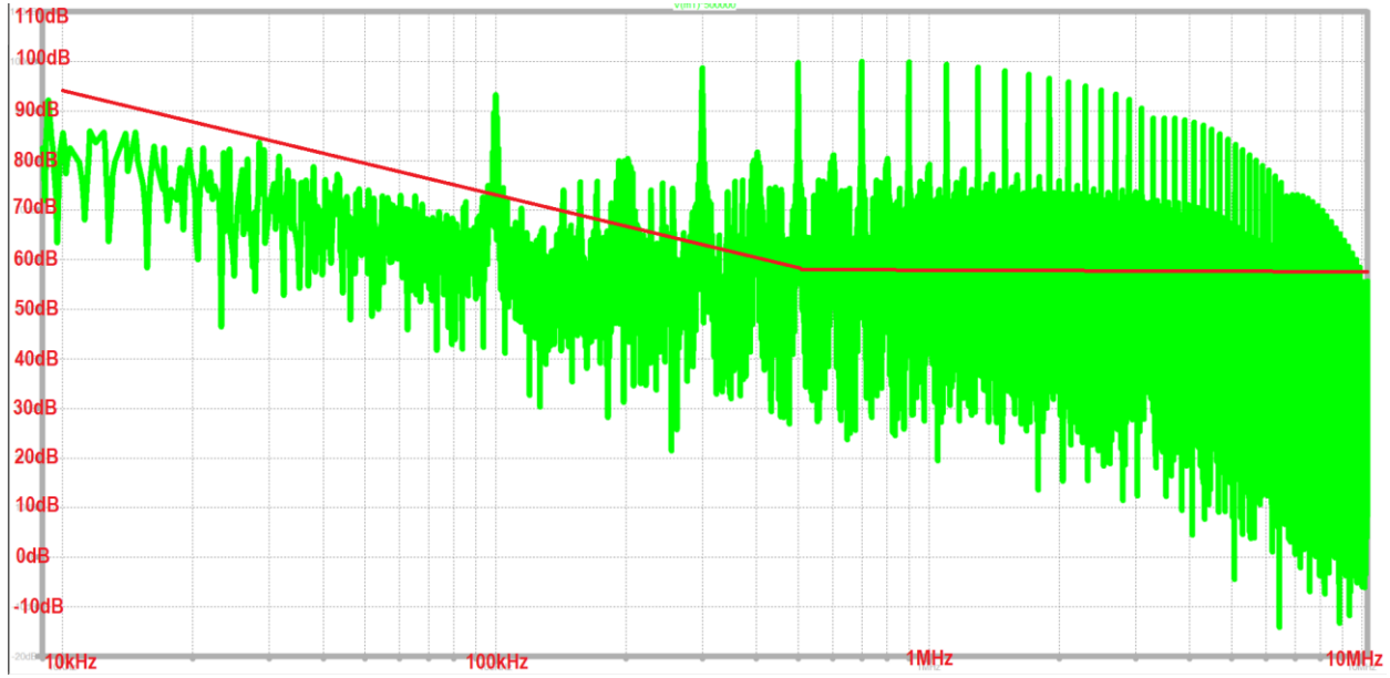
Şekil 11. AA/DA dönüştürücü devresinin fark mod filtre olmadan ortak mod gürültü grafiği
