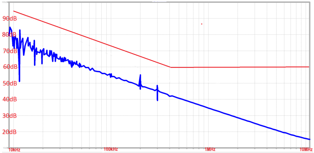
Şekil 14. Ortak mod filtre eklendikten sonra ortak mod gürültüsü
