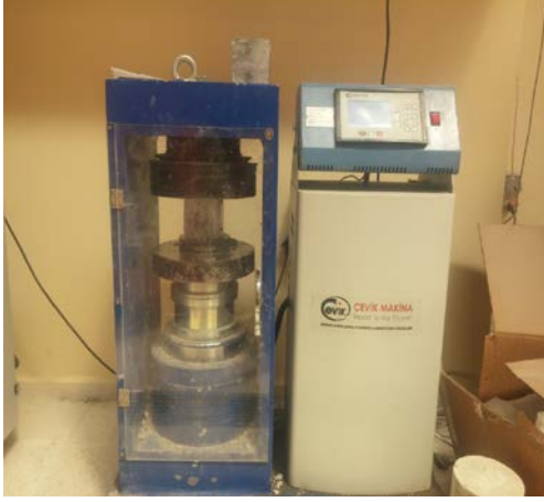
Şekil 5. Beton Presi ile Basınç Deneyi
