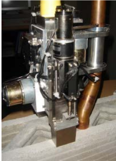
Şekil 2. Betondan Yapı Elemanı Üreten Nozzle (Khoshnevis, 2015)
