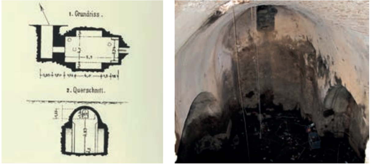
Şek. 18 - Anemas Kulesi'nin Doğusundaki Sarnıç. Plan, kesit (Forchheimer-Strzygowski, 1893) ve sarnıcın içten görünümü (Kerim Altuğ).
