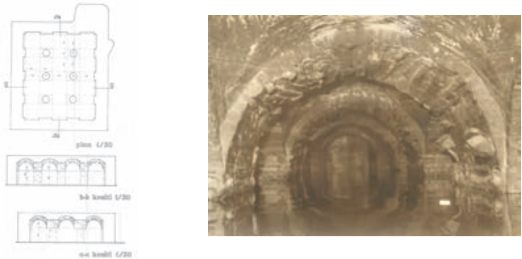
Şek. 11 - Akgün Otel Sarnıcı. Plan, kesit ve sarnıcın içten görünümü (Koruma Kurulu Arşivi).
