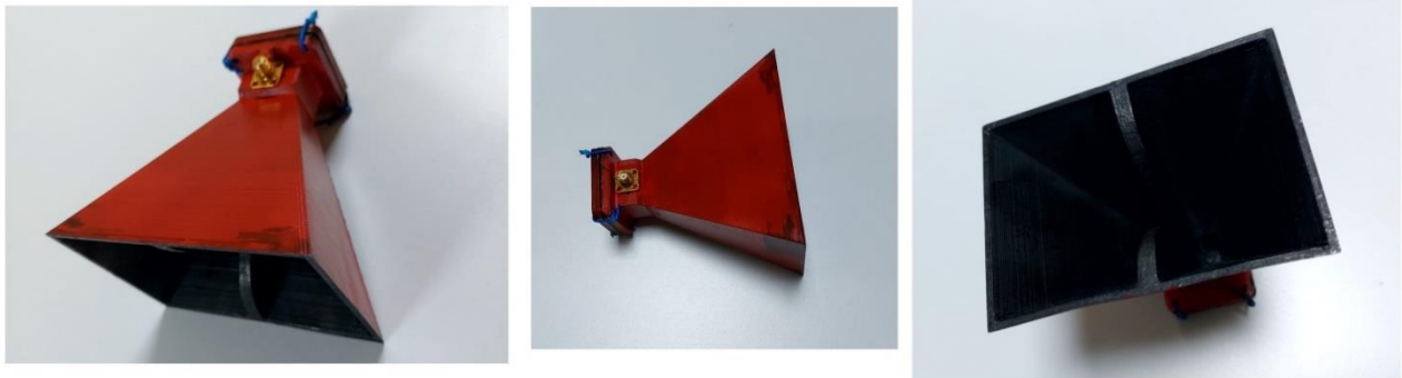
Şekil 2. Çift sırtlı horn anten perspektif, üstten ve önden görünümü
