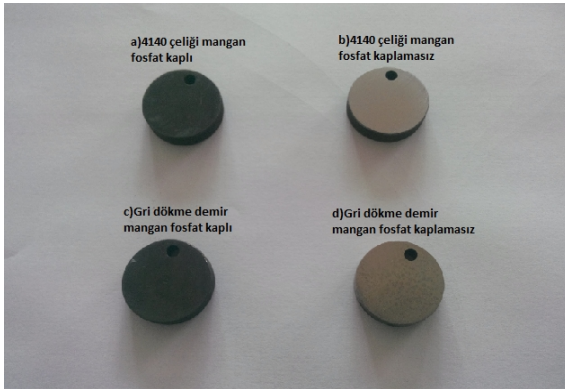
Şekil 1. Deneylerde kullanılan kaplamalı ve kaplamasız numuneler.
