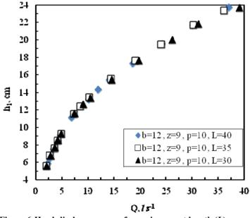
**Figure 6-Head-discharge curves for various crest length (***L***)** *Şekil 6-Çeşitli eşik uzunlukları için ana debi eğrileri*
