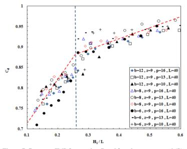
Figure 7- $C_d$  versus  $H_1/L$  for varying P and b and constant z and (L)Şekil 7-Değişen P ve b ve sabit z ve L için  $C_d$ - $H_1/L$  grafiği
