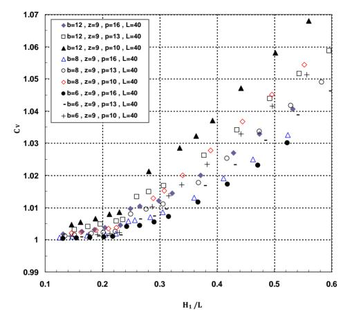
**Figure 10-CV versus**  $H_1/L$  for varying *L* and *P*; constant *z* and *L* Sekil 10-Değişen *L* ve sabit *z* ve *L* değerlerinde *CV*- $H_1/L$  grafiği
