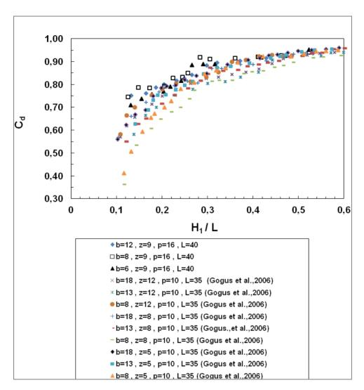
Figure 9-Comparison among Cd versus  $H_1/L$  in present study with Gogus et al (2006) Sekil 9-Cd-H1/L ilişkisinin bu çalışma ile Gogus et al. 2006 yapılan çalışma arasındaki karşılaştırması
