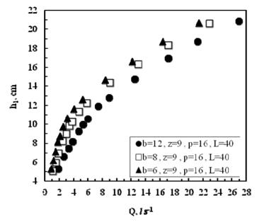
**Figure 5-Head-discharge curves for various crest width (b)** *Şekil 5-Çeşitli eşik genişlikleri için su ana debi eğrileri*
