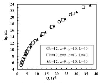
**Figure 4-Head-discharge curves for various weir height (P)** Sekil 4-Cesitli savak yükseklikleri icin ana debi eğrileri
