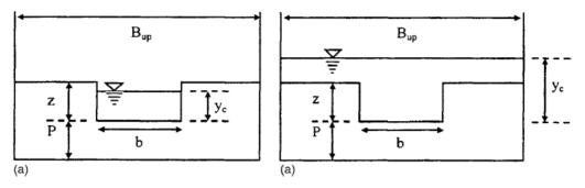
**Figure 3-Two different flow cases through weir section: (a) Case 1; (b) Case 2** *Şekil 3-Savak kesitinden geçen iki farklı akış durumu (a) Durum 1; (b) Durum 2*
