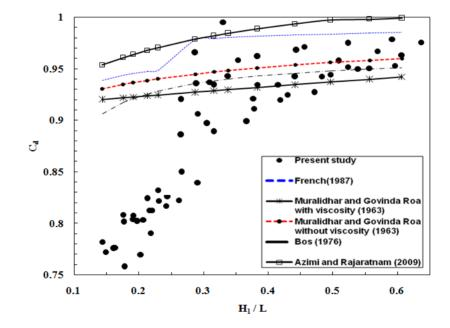
**Figure 8-Comparison among Cd versus**  $H_1/L$  **in present study and others** *Şekil 8-C<sub>d</sub>-H*<sub>1</sub>/*L ilişkisinin bu çalışma ile diğer çalışmalar arasındaki karşılaştırması*
