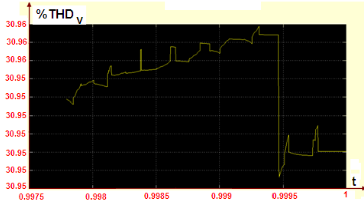
Şekil 7. Üç seviyeli diyot kenetlemeli eviricinin çıkış gerilim THDV değişimi
