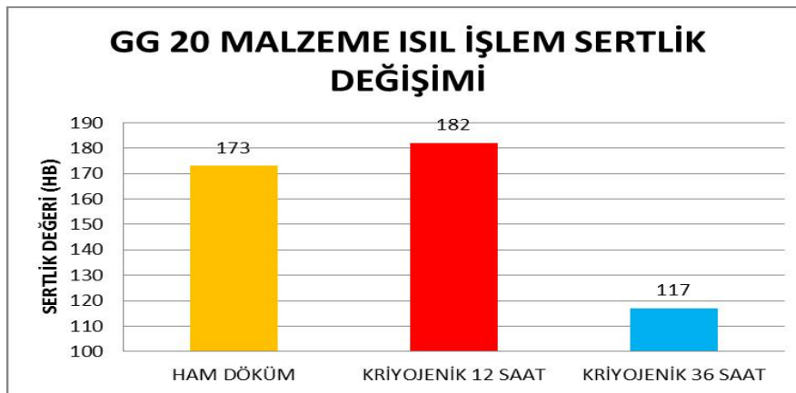
Şekil 3. Kriyojenik işlem sonrası gri dökme demir malzeme sertlikleri (After Cryogenic Processing grey cast iron Hardness Value)
