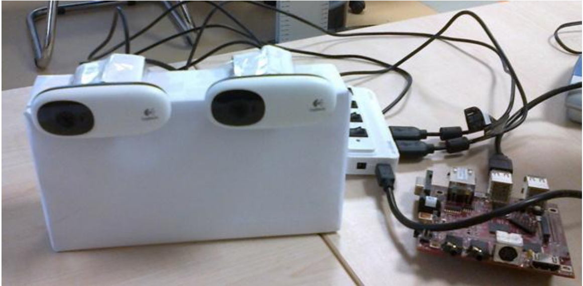
Şekil 8. Mesafe kestirim uygulamasında BeagleBoard-xM kullanılması [1,27]
