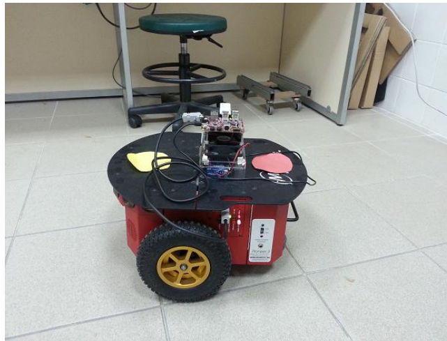
Şekil 5. Gezin Robot uygulamasında BeagleBoard-xM kullanılması [1, 26]
