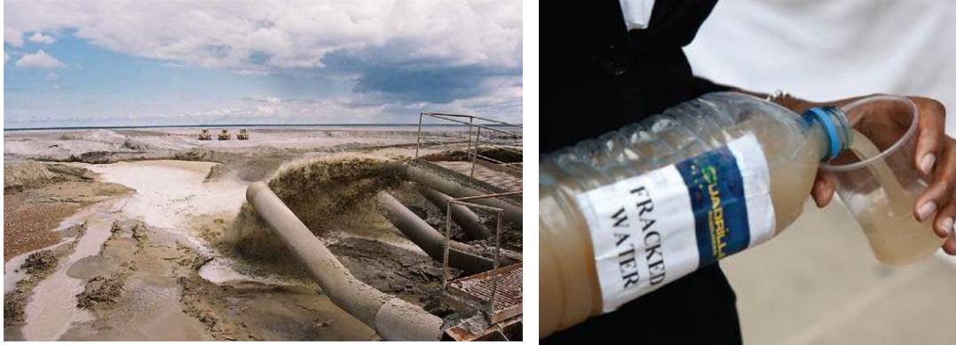
Şekil 6. Şeyl gazı üretimi yapılan bir sahada geri alınan suyun depo alanına atılması ve alınan su örneği (shalegas-europe.eu).
