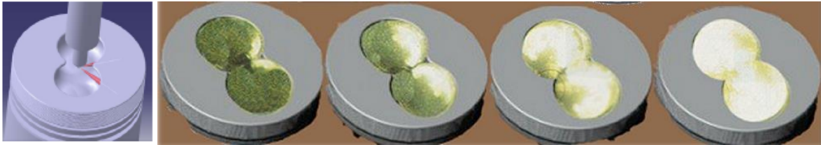
Şekil 4. Çift Döngülü MR-2 yanma odasında "MR-Process" Yanma Mekanizmasının Dizel Prensibi ile gerçekleştirilme şeması.
