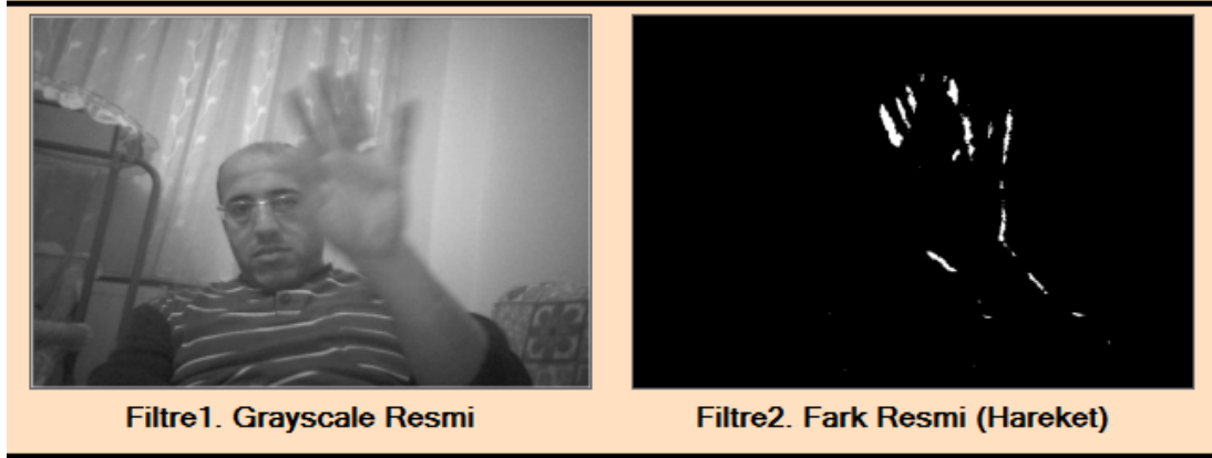
Şekil 4. Filtreler ile elde edilen gri-ton ve fark resimleri.
