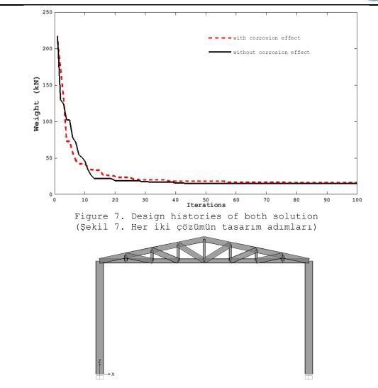
Figure 8. Industrial structure with optimum profiles without corrosion effect (Şekil 8. Korozyon etkisi olmadan endüstriyel yapının optimum profilleri)
