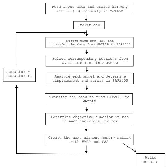
Figure 1. Flowchart for the optimum design procedures (Şekil 1. Optimum tasarım işlemi için akış şeması)
