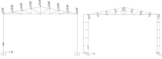
a)Dead Loading (Ölü yükler) (Rüzgar yükleri (X yönündeki rüzgar)) Figure 6. The loading in consideration (kN-m) (Şekil 6. Dikkate alınan yükler (kN-m))
