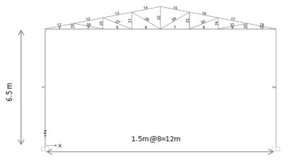
Figure 5. 31-member industrial structure (Şekil 5. 31-Elemanlı endüstriyel yapı)
