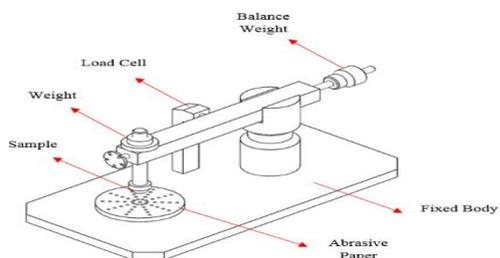
**Fig. 3.** Pin-On-Disk Wear Device
