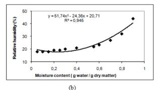
Figure 2. Graph of change in drying air temperature in accordance with time (a) and change in relative humidity due to the drying (b) (Zamana göre kurutma havası sıcaklığında değişim grafiği (a) ve kurutma nedeniyle bağıl nemdeki değişim grafiği
