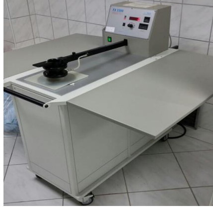
Şekil 6. TS 391 Hava Geçirgenlik Testi Makinesi
