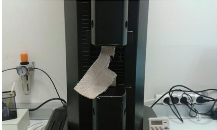
Şekil 5. TS EN ISO 13937-2 Tek Yırtma Testi Makinesi
