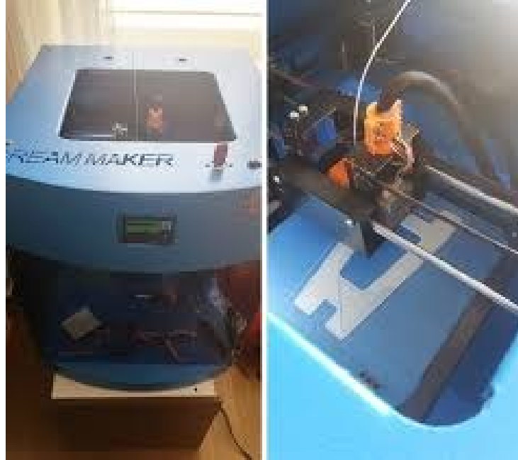
Şekil 1. Açık kaynak kodlu Dream Maker 3B yazıcı
