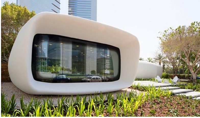
Şekil 3. Tamamen 3B yazıcılar ile üretilmiş Ofis binaları [23]
