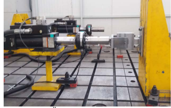
Şekil 15. Ömür testleri MTS test sisteminde gerçekleştirilmiştir.
