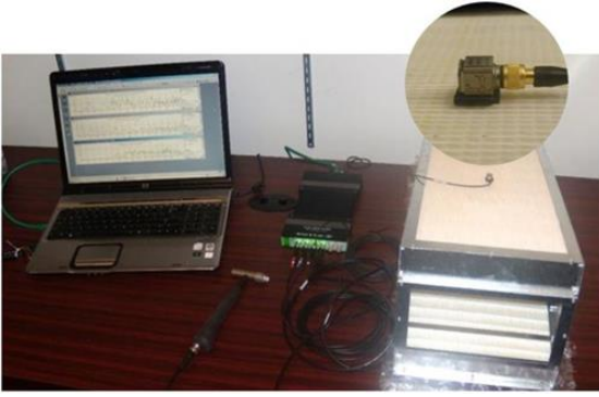
Şekil 9: Filtre kâğıdının FFT analizi için çekici deney düzeneği.
