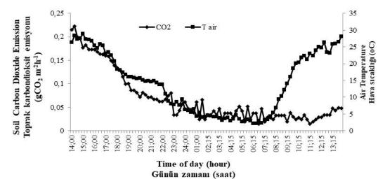
Figure 2. The relationship between carbon dioxide (CO<sub>2</sub>) emission and air temperature ( $T_{air}$ ) *Sekil 2. Hava sıcaklığı (T\_{hava}) ve karbondioksit emisyonu (CO<sub>2</sub>) arasındaki ilişki*
