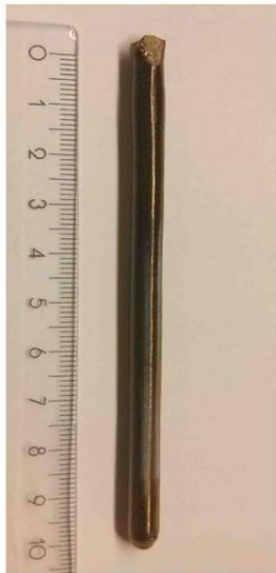
Şekil 3. Üretilen numunenin çubuk şeklinde döküm kalıbından çıkarılmış hali
