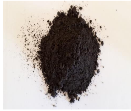
Şekil 1. BSCCO (2234) bileşiğinin kalsinasyon işleminden sonraki öğütülmüş durumu.
