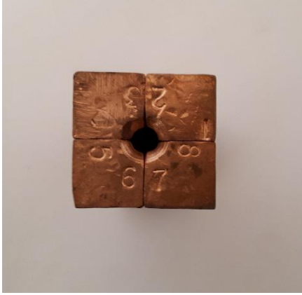
Şekil 2. Eriyik haldeki BSCCO (2234) bileşiğinin döküm yapılacak kalıbı.
