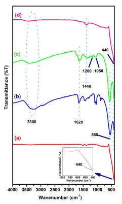
Figure 4. FT-IR spectra of (a) ZnO, (b)  $NiFe_2O_4$ , (c)  $NiFe_2O_4/TA$  and (d)  $NiFe_2O_4/TA/ZnO$ .
