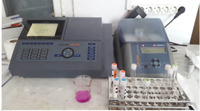
Şekil 1. Analizlerde kullanılan spektrofotometre ve termo reaktör cihazlarının gösterimi
