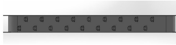
Şekil 19. Tasarlanan kaşıkçık tipi önerisinin bant üzerindeki konumu
