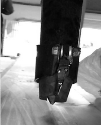
Şekil 12. Dikici ayak içerisine yerleştirilen metal plaka
