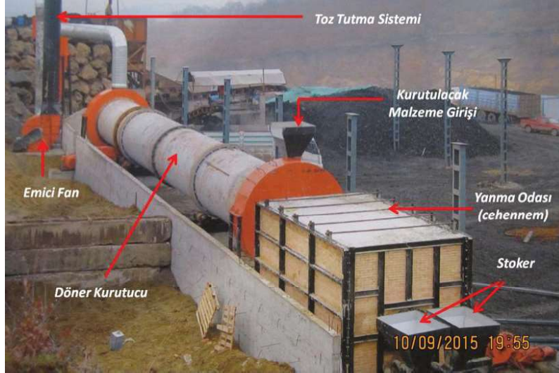
Şekil 2. Döner kurutucu ve yardımcı ekipmanlarının görüntüsü (Özsu,2017)
