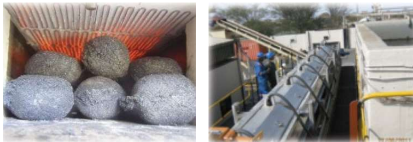
Şekil 13. Parsep kurutucunun iç infrared görüntüsü ve dıştan görünümü
