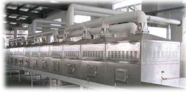
Şekil 12. Mikrodalga ışınli kurutucu (Max, 2017).
