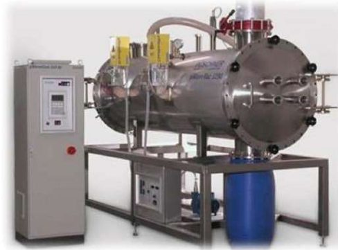
Őekil 10. Mikrodalga ısıtmalı vakumlu kurutma makinesi (Pueschner, 2016)
