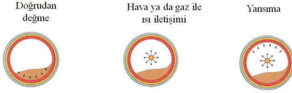
Şekil 1. Kurutucuda ısı-malzeme iletişim yöntemlerinin şematik görünümü
