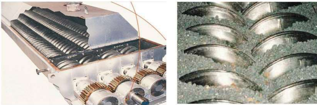
Şekil 8. Helezonlu kurutucu (Holo-flite) ve endüstriyel görüntüsü
