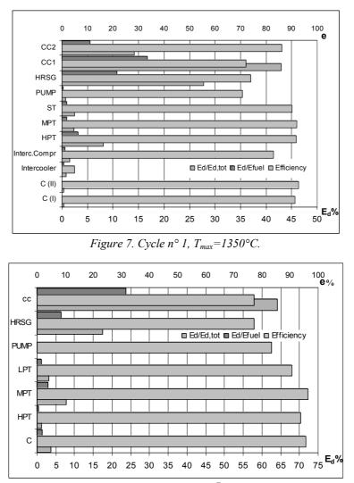
Figure 8. Cycle n° 3, ZECOTECH<sup>®</sup> (T<sub>max</sub>=1350°C).
