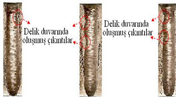
Şekil 5. Delik duvarlarındaki bazı geometrik bozukluklar (Some geometric misforms on hole walls)
