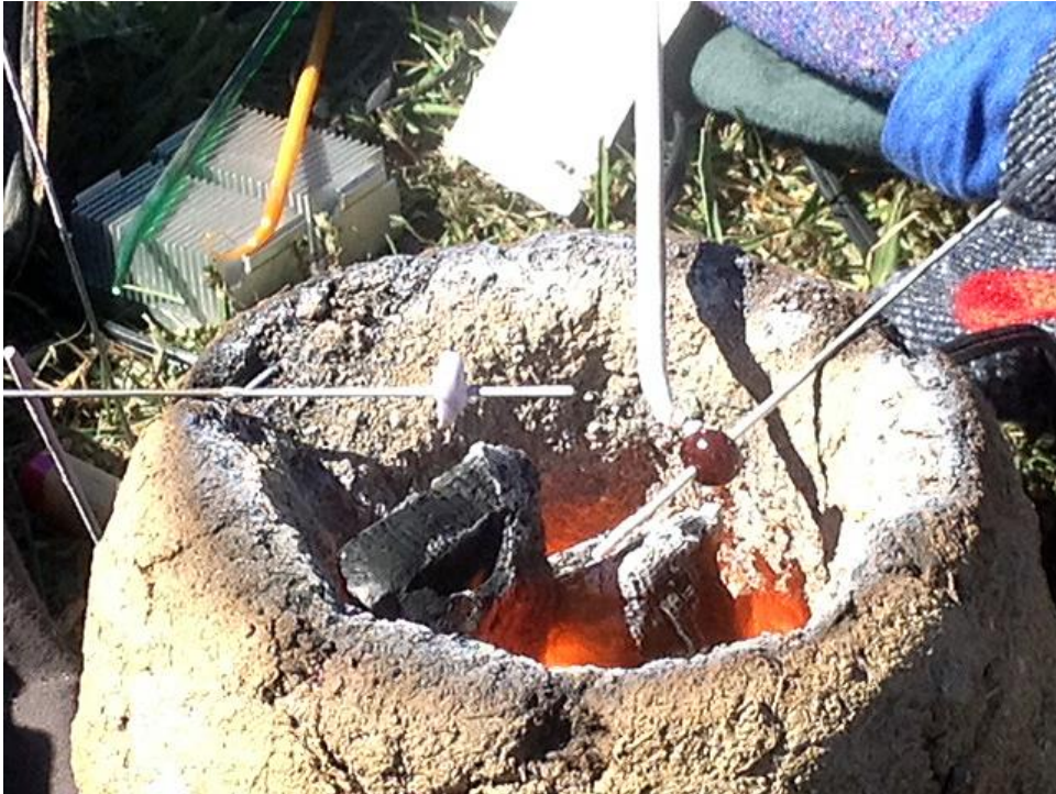
Şek.17: Kapaksız tandır formundaki fırınla cam üretimi.
