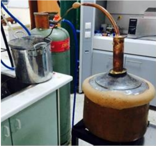
Şekil 1: Distilasyon ünitesi ile birlikte bakır Boğma üretim kazanı
