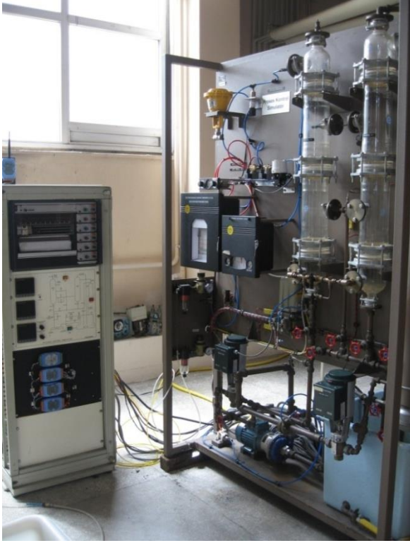
Şekil 1. Kablosuz ölçüm ve kontrol için geliştirilen proses kontrol simülâtörü (Developed process control simulator for wireless measurement and control)
