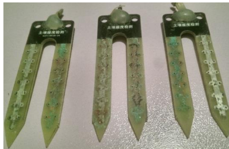
Şekil 6. Okside olmuş sensör örnekleri
