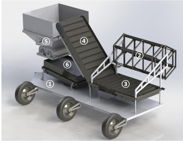
Şekil 5. Makinanın genel şematik görünümü (1: Şasi, 2: Dolap, 3: Yatay konveyör, 4: Eğimli konveyör, 5: Harmanlama ünitesi, 6: Ayırma ünitesi)
