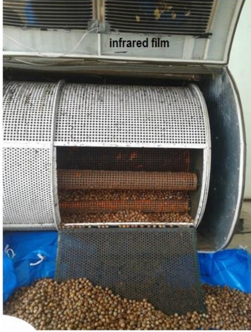
Şekil 1. Test edilen fındıklar ve makina üzerinde infrared filmler
