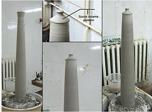
Görüntü 18. Baş kısmın sucuk dolama yöntemi ile kapatılması ve kulpun yapılması.
