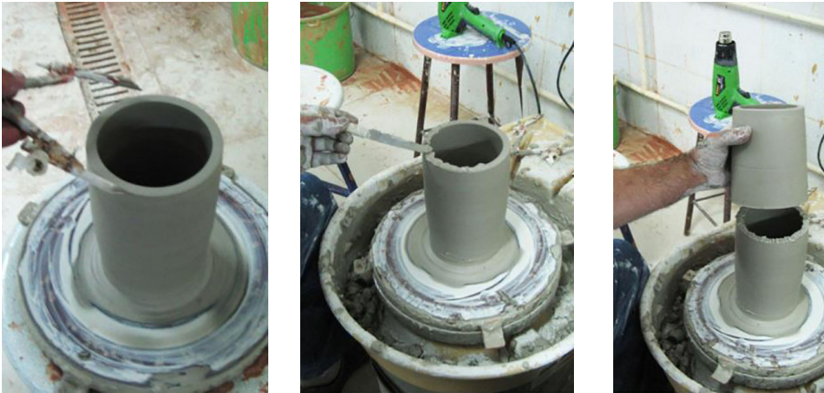
Görüntü 12. İkinci parçanın birleştirilmeden önce ağız çapının ölçülmesi, birleşme yüzeyine balçık sürülmesi ve iki parçanın birleştirilmesi işlemi.
