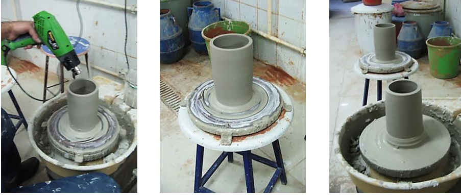
Görüntü 11. Ayrı bir yere kaldırılmış tabla üzerindeki temel parça ve şekillendirme işlemi bitmiş ilk iki parça.
