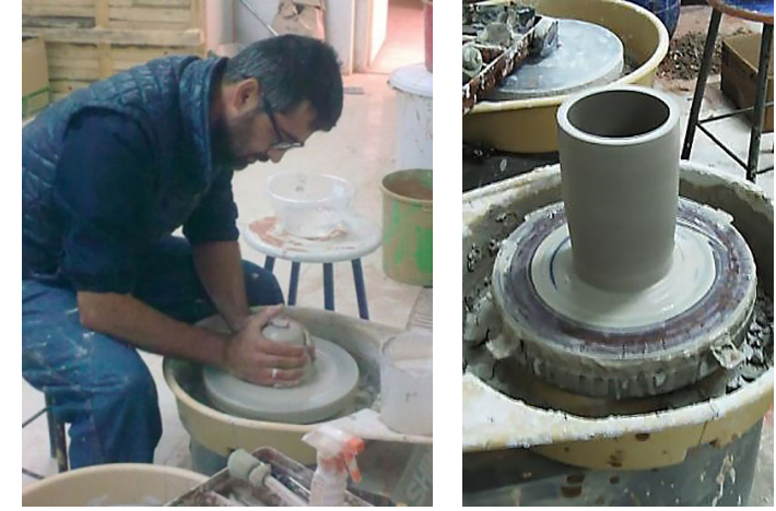
Görüntü 10. Merkezleme işlemi ve şekillendirilmesi tamamlanmış temel parça.
