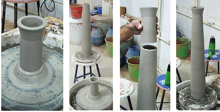
Görüntü 17. Son parçanın (baş kısmın) çekilmesi ve ana bünyeye eklenmesi.
