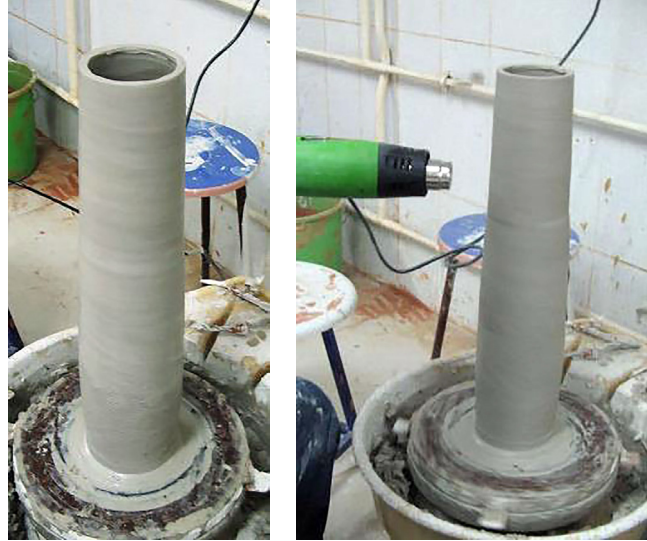
Görüntü 14. Üçüncü parçanın çekilmesi ve ekleme işlemi.
