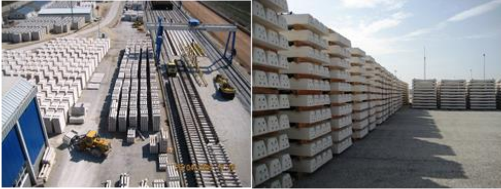
Şekil 5. Stoklanan Traversler ve panel alanı[21]
