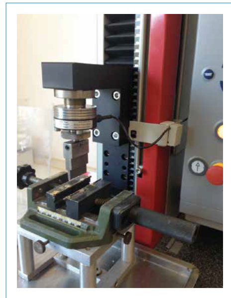
Şekil 2 | Üç nokta bükme testi için kullanılan Zwick-Roell cihazı.
