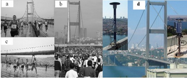
Şekil 5: Maraton sırasında ortaya çıkan farklı yükler (a-b-c) altında 20 numaralı noktanın P7 numaralı referans noktasından RTK-GPS ile ölçülmesi (d)
