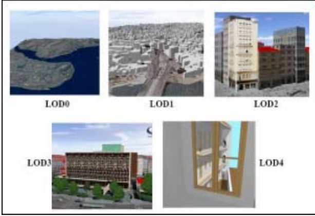
Şekil 7: CityGML'in önerdiği ayrıntı düzeyleri.
