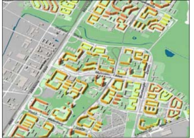
Şekil 1-b: Binaların depreme karşı dayanıklılığını gösteren 3B kent modeli örneği (DÖLLNER vd. 2006)
