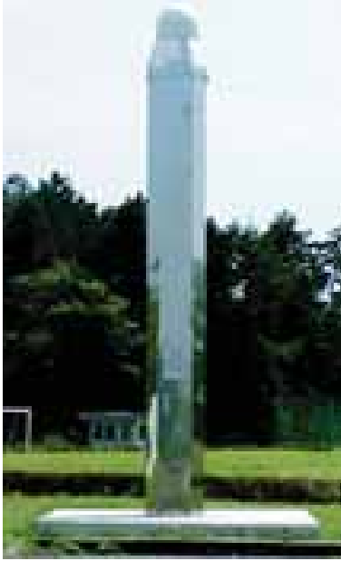
Şekil-7. GEONET referans İstasyonu
