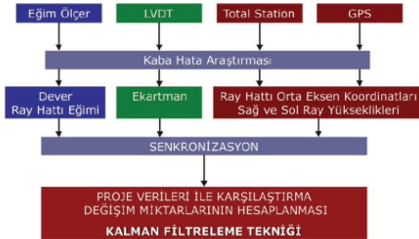
Şekil 8: Verilerin değerlendirilmesi için akış diyagramı.
