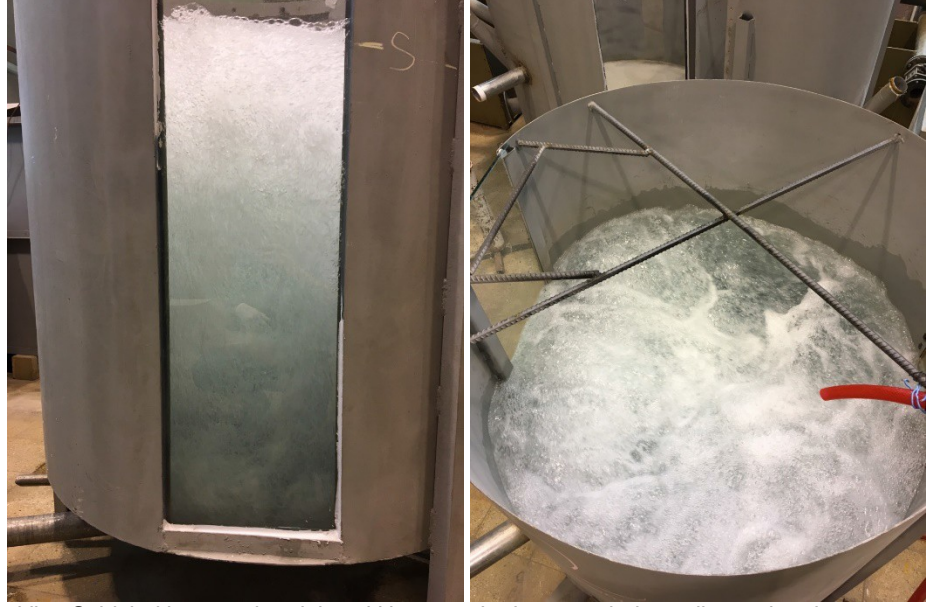
Şekil 6. Sabit hol boyu ve konduit açıklık oranında d=15 mm hol çapı ile yapılan deney sonucu meydana gelen kabarcıklar (Şekerci, 2017).
