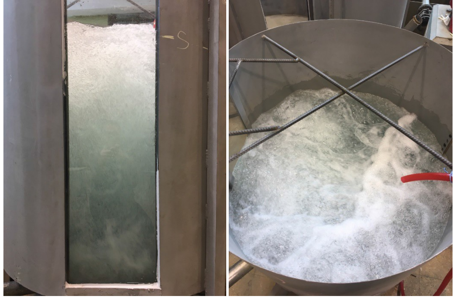
Şekil 8. Sabit hol boyu ve konduit açıklık oranında d=35 mm hol çapı ile yapılan deney sonucu meydana gelen kabarcıklar (Şekerci, 2017).
